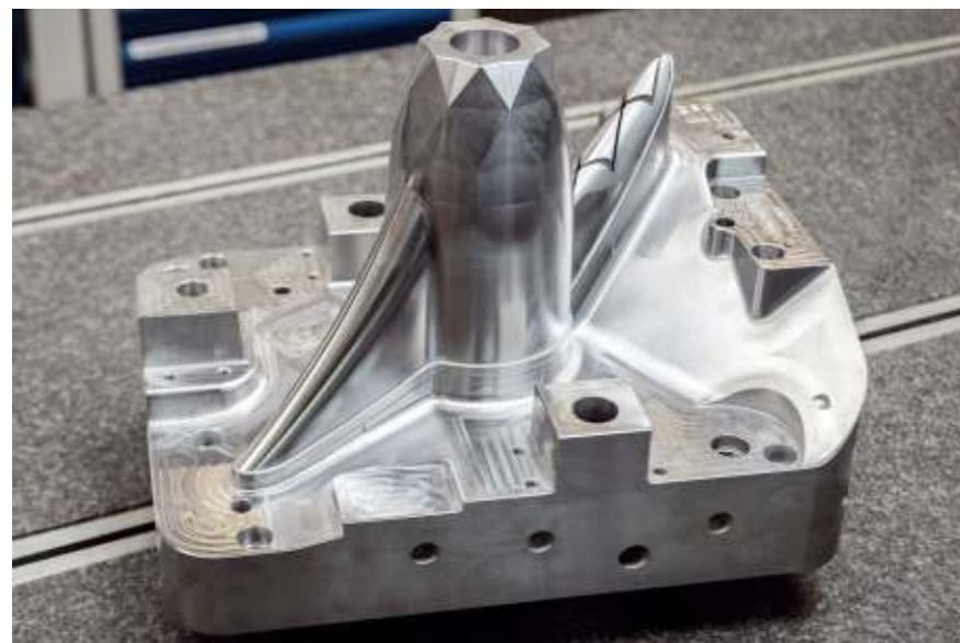
Dieses Tauchkantenwerkzeug für eine geschäumte Gießkanne steht stellvertretend für die vielen Projekte, die im Rahmen der Road of Tooling Innovation vorgestellt wurden © Deckerform
