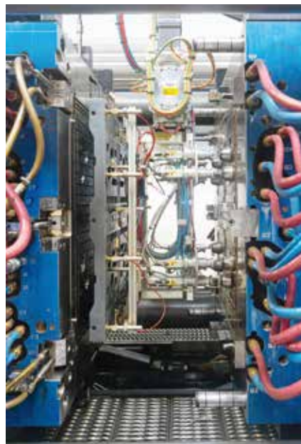
Blick ins Spritzgießwerkzeug für das Palettendeck: Der Roboter entnimmt links das fertige Deck und platziert rechts die TPE-Einleger für die nächste Palette.
