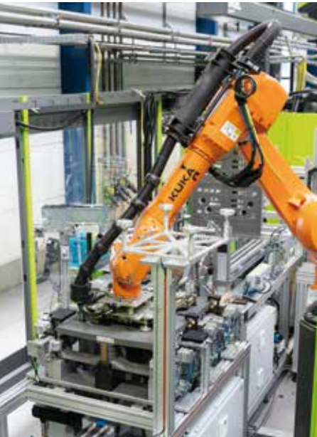
In der vollautomatischen Palettenmontage drückt der Roboter das Deck auf die drei Kufen.
