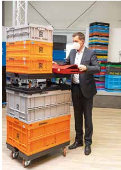
Ein „Warenhausversandturm“ besteht aus einem Rollwagen und aufgestapelten Faltschalen.
