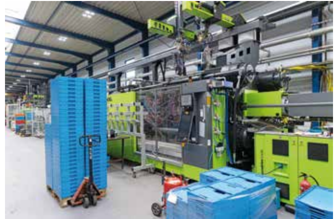
Spritzgießmaschinen um die 10.000 kN Schließkraft und Etagen-Familienwerkzeuge sind bei Walther Standard zur Herstellung von faltboxen.
