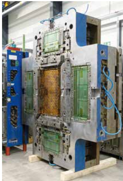
Ein typisches Spritzgießwerkzeug für fünf der acht Elemente einer Faltdbox.
