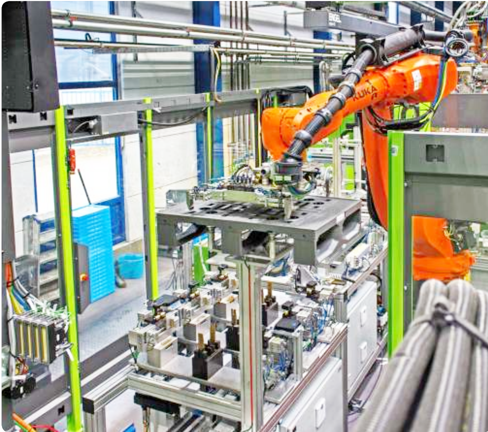
Kufen und Deck der Paletten werden synchron produziert. Ein Roboter zwischen den Maschinen montiert sie und legt sie ab. (Bild: Walther Faltsysteme)
